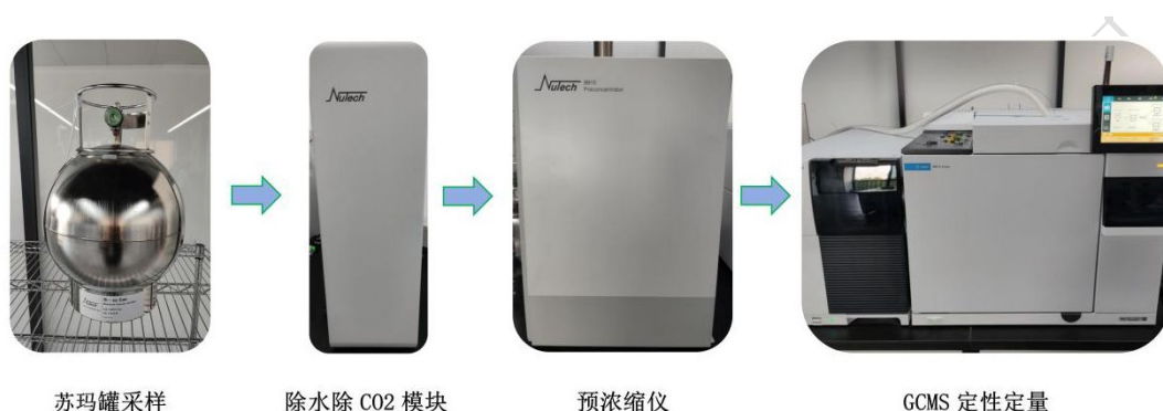
图 1 苏玛罐采样、除水除 CO 2 模块除水除 CO 2 、预浓缩仪处理、GC-MS 定性定量分析系统
